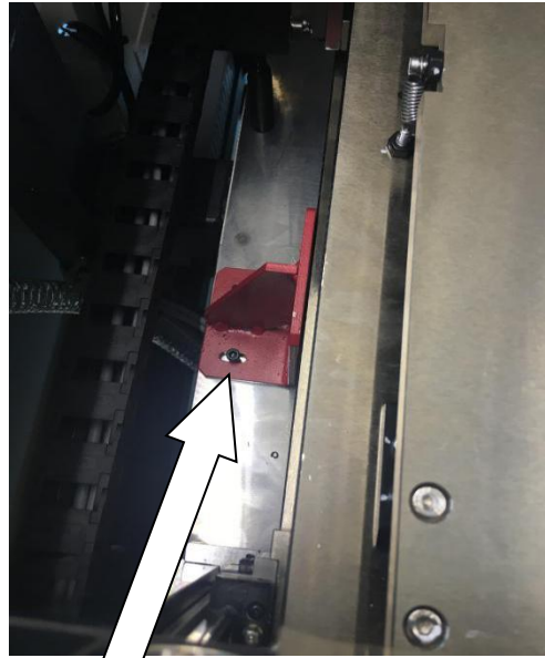
图 2-1工作台固定板（红色） Fixed plate on the table (red section)
